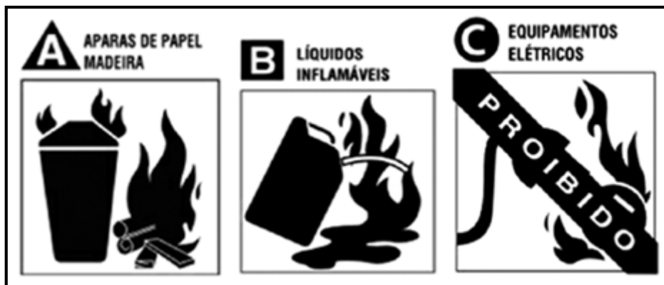
Figura 11 – Símbolos gráficos de extintores de espuma (classe A e B) Fonte: SEITO et al.,2008
